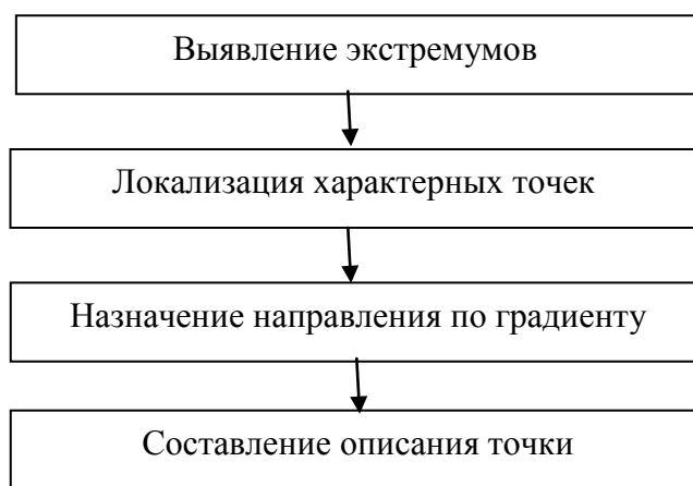
Рисунок 6 – Схема работы алгоритма SIFT
