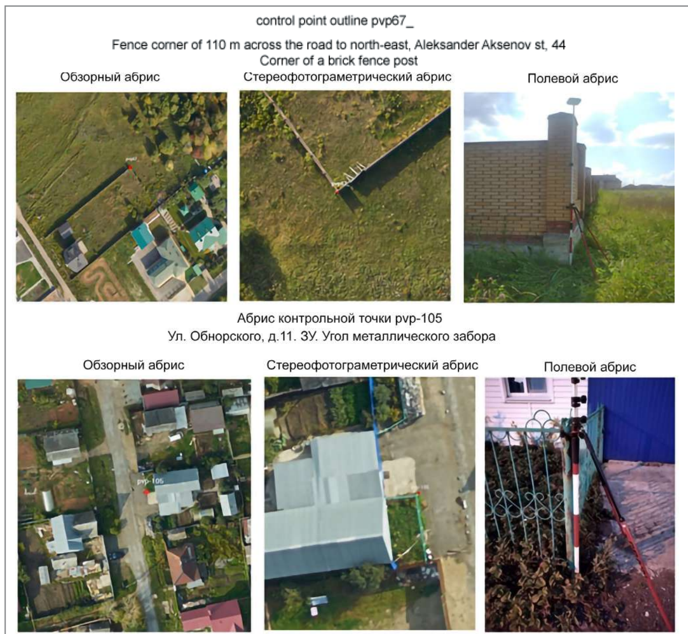
Рис. 2. Примеры абрисов контрольных точек различных типов
