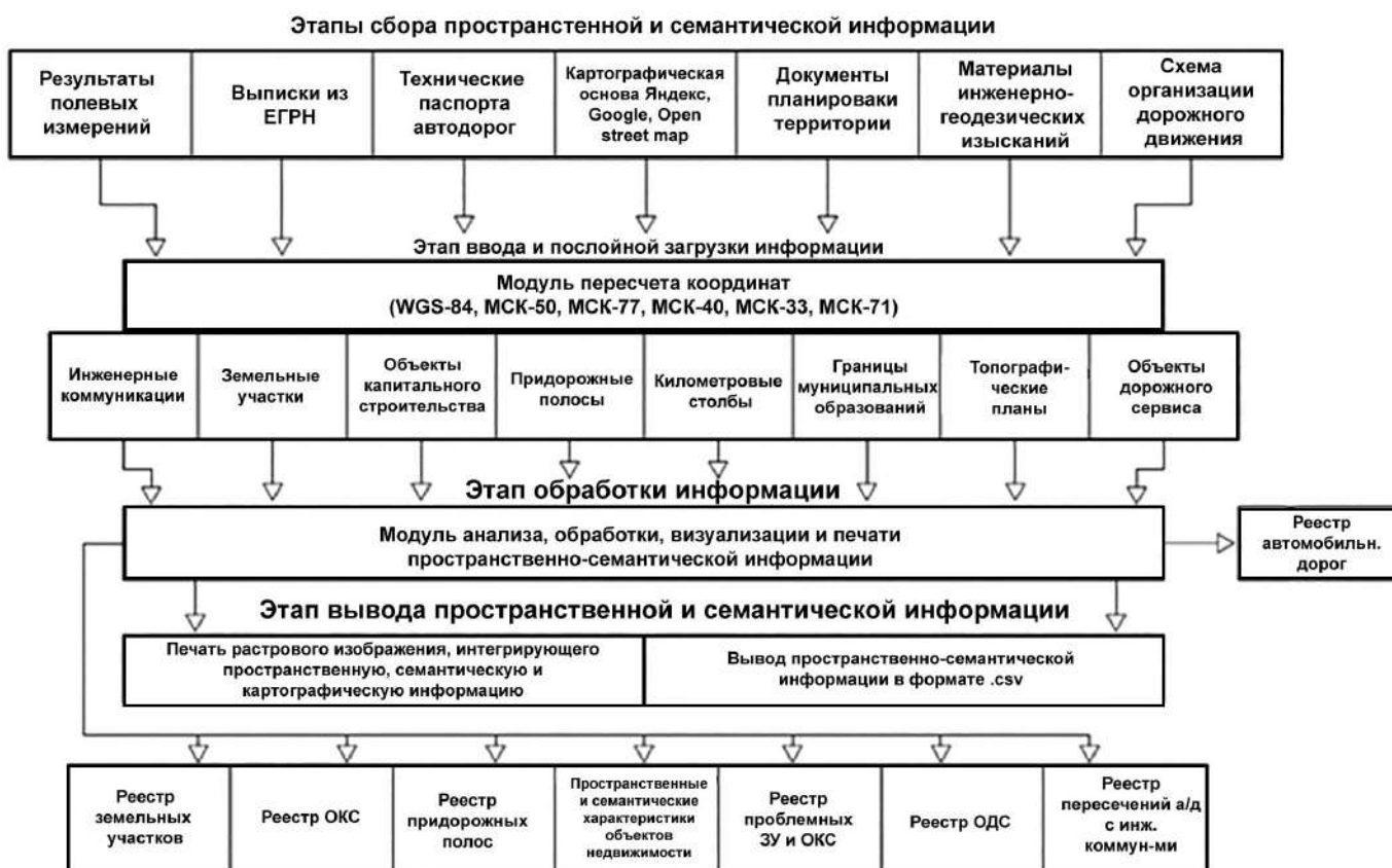
Рис. 6. Архитектура средства геоинформационного обеспечения
