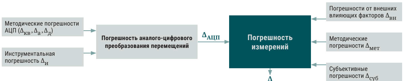
Рис. 3 Схема формирования погрешности измерений при АЦП.
