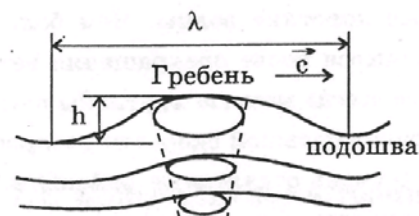
Рис.6.1.1. Траектории движения частиц жидкости в волне.
