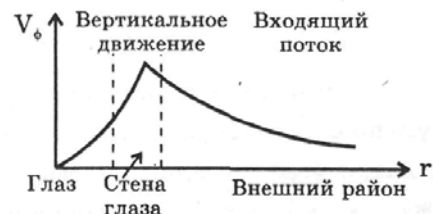
Рис. 7.3.1. Горизонтальное распределение скорости ветра в слое входного потока.
