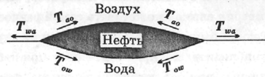
Рис. 4.3.1. Силы поверхностного натяжения, действующие на пятно нефти на поверхности воды.
