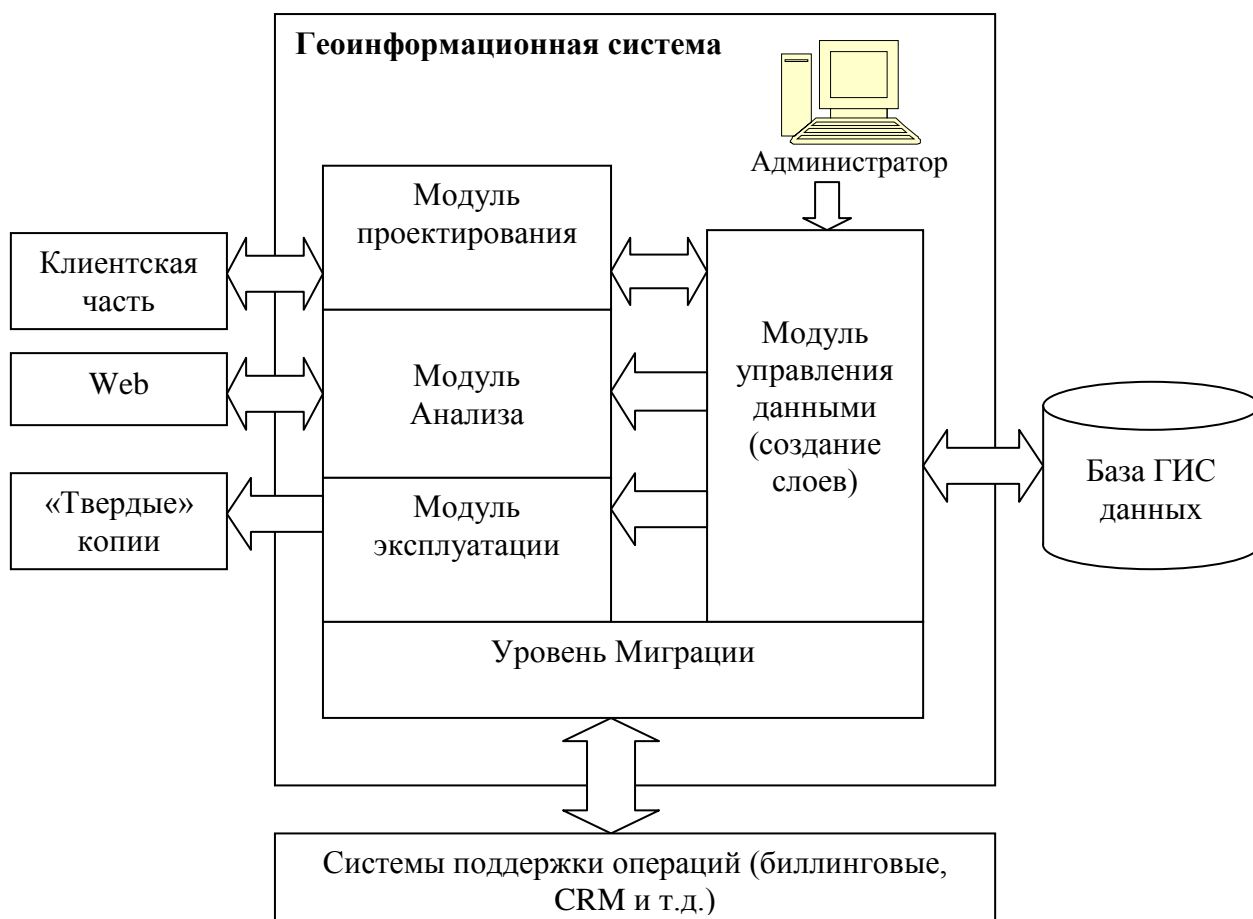
Рис. 2 Общая архитектура информационно-телекоммуникационной системы на основе ГИС-технологий
