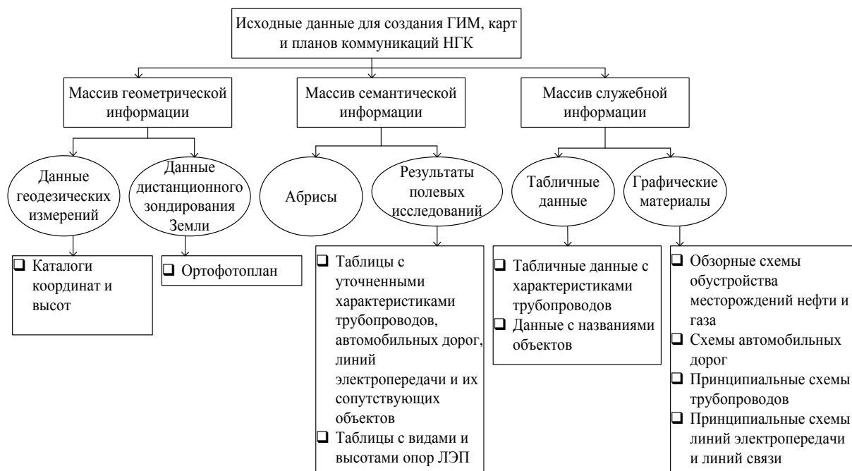
Рисунок 1 – Структура исходных данных для создания ГИМ, карт и планов коммуникаций НГК
