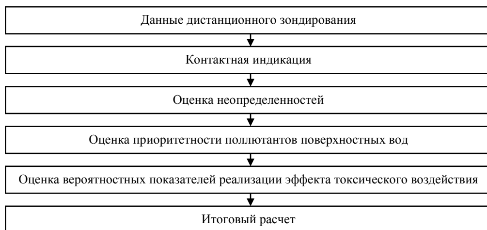
Рис. 4. Методика оценки экологического риска загрязнения водного объекта с использованием материалов дистанционного зондирования
