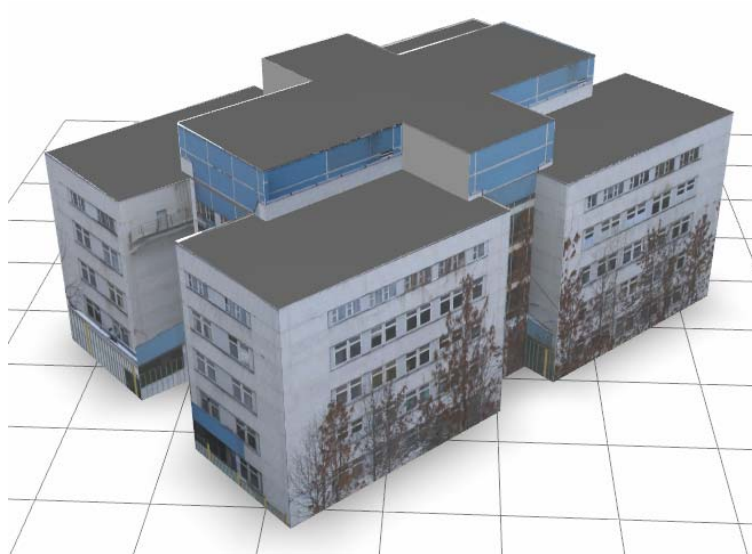
Рис. 4 - Модель здания, автоматическое создание ЦМП и текстур
