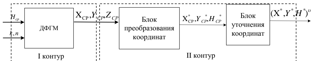
Рисунок 7 – Блок-схема методики координатной привязки
