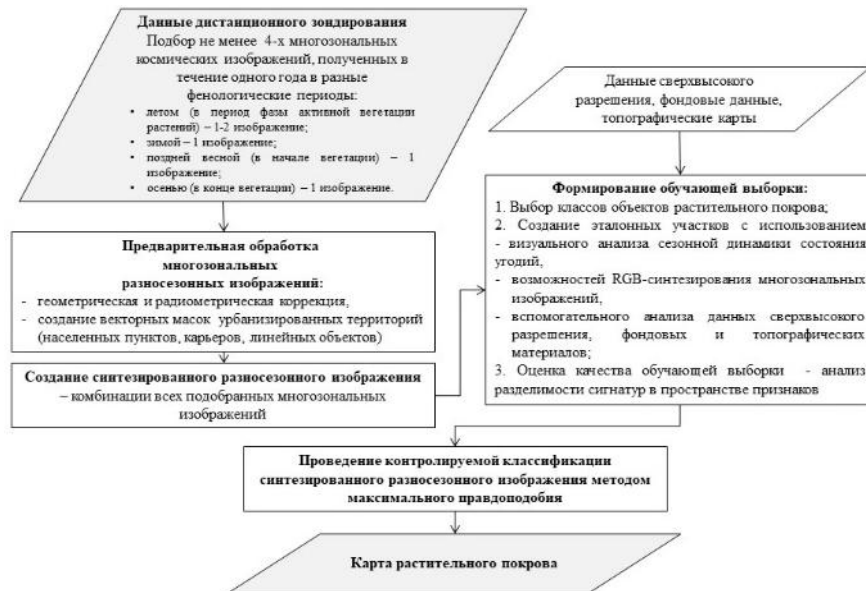
Рисунок 3 – Схема создания карты растительного покрова с использованием методики автоматизированного дешифрирования разносезонных зональных космических изображений
