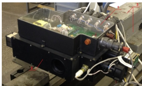
Рисунок 9 – Макетный образец Лазерного Автоколлимационного Микроскопа.
