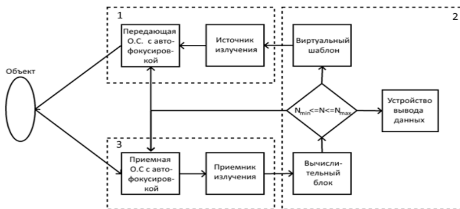
Рисунок 1. Функциональная схема опико-электронной системы измерения параметров движения
