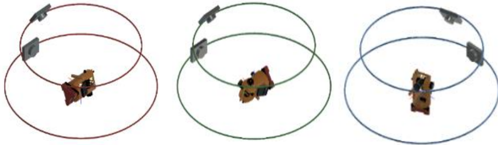
Рисунок 4 – Положение маршрутов для съёмки ОКН сложной конфигурации
