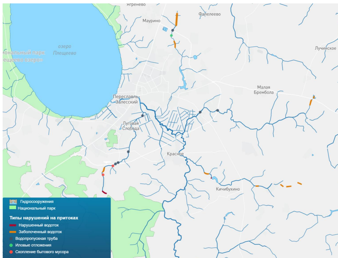
Рис. 13. Карта-схема проблемных участков на притоках р. Трубеж – р.Ветлянка, р.Воргуша, р.Кипс и р.Мурмиш, выявленных во время полевого обследования (июль 2024 г.)
