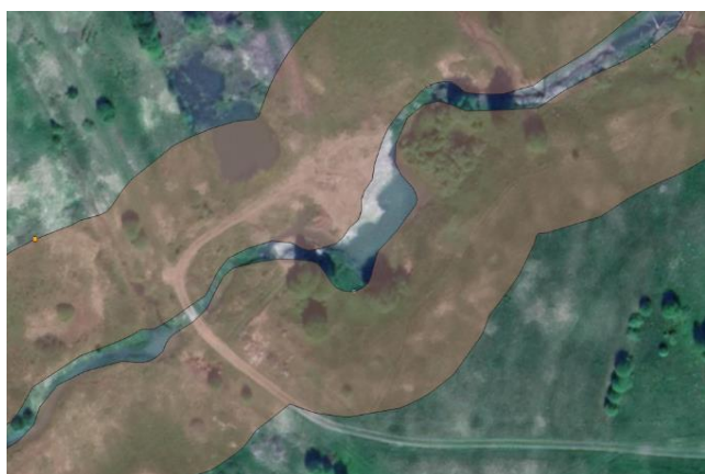
Рис. 8. Река Мурмиш. Расширение русла и изменение окраски воды в местах пересечения с транспортными коммуникациями. Коричневым цветом обозначена прибрежная защитная полоса. (4338606.6 7702512.3)
