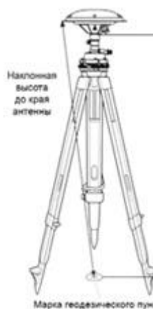
Рисунок 4.2. Схема измерения высоты антенны
