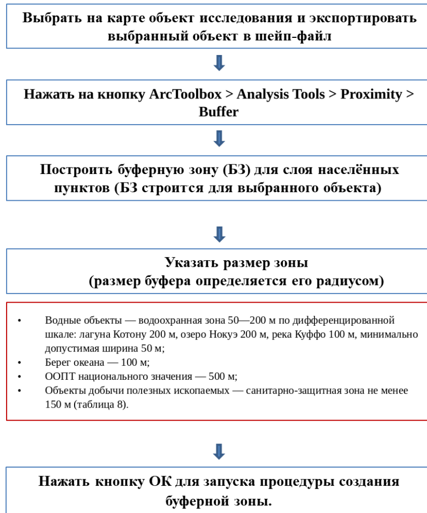
Рисунок 18 — Технология создания проекта буферных зон
