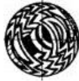
Рисунок 20 – Системы интерференционных колец при наличии погрешности центрирования у контролируемой линзы.
