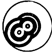
Рисунок 15 – Интерференционная картина при наличии погрешности центрирования.
