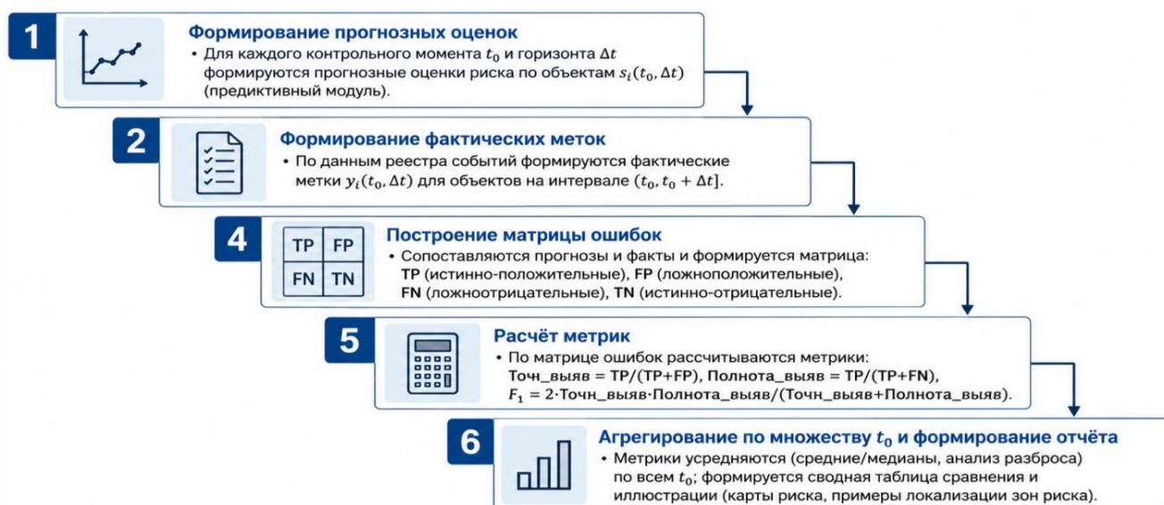
Рисунок 4.19 – Последовательность расчета значений метрик: t_0 – контрольный момент; \Delta t – горизонт прогноза; s_i(t_0, \Delta t) – прогноз угрозы по объекту i ; y_i(t_0, \Delta t) – фактическая метка (1 – неблагоприятное событие наступило, 0 – не наступило);
