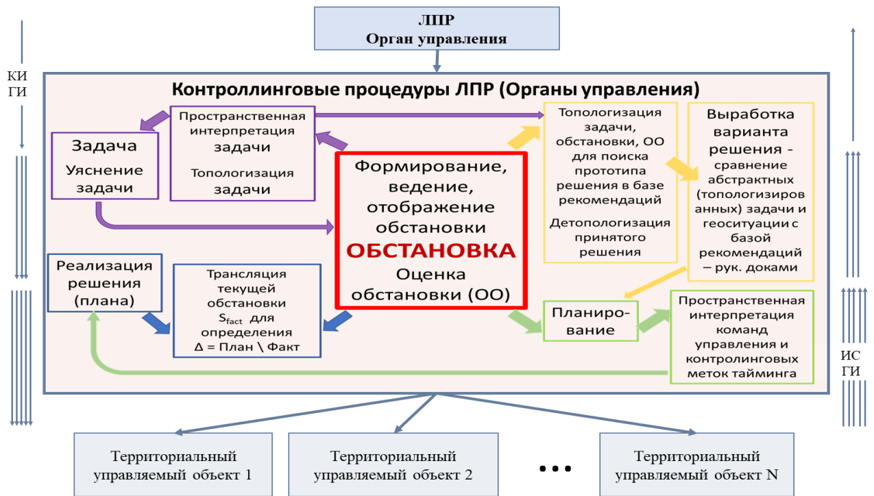
Рисунок 2.2 – Структура геоконтроллинга территориальными объектами и системами, в т. ч. поддержанием технической готовности ОММ РСЛЦ: ЛПР (Руководитель) – лицо, принимающее решения; КИ – командная информация (информация прямой связи); ИС – информация состояния (информация обратной связи); ГИ – геоинформация; ОО - оценка обстановки; S_{fact} – текущая обстановка (геоситуация); План – командная информация; Факт – информация состояния; \ - операция вычитания множеств
