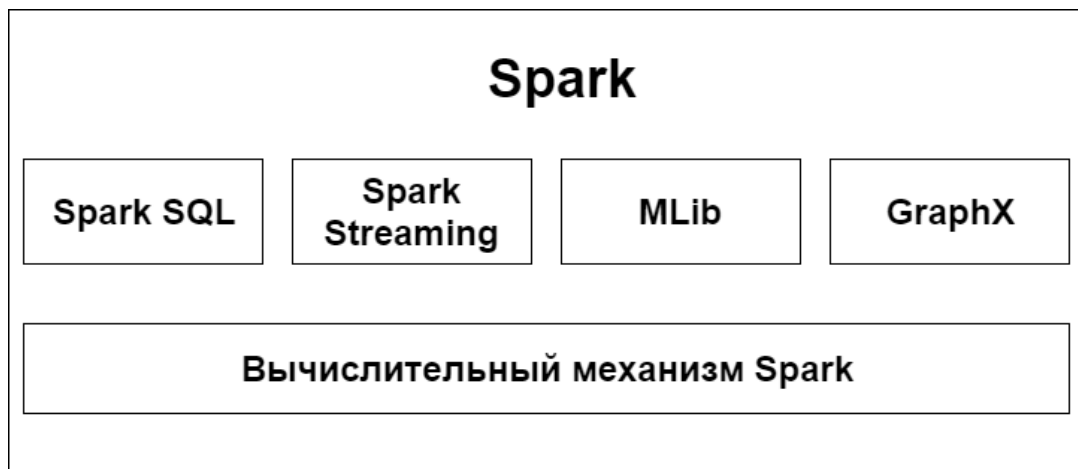
Рисунок 4.2 Общий вид архитектуры программной среды Spark
