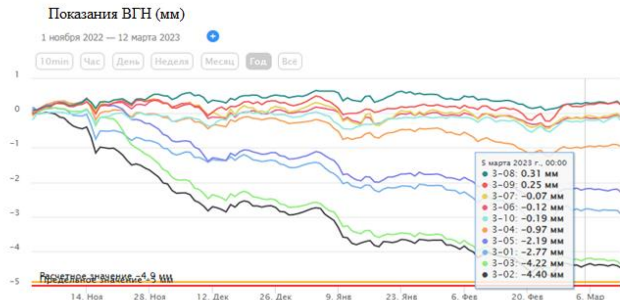
Рисунок 3.39 Изменения с момента начала мониторинга высотных положений контролируемых точек основания здания по адресу: г. Самара, ул.Галактионовская, д.141 при проходке открытым способом тоннеля метрополитена
