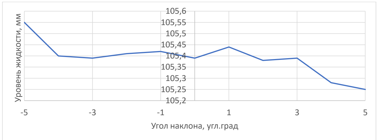
Рисунок 3.6 Зависимость измеренного уровня жидкости от угла наклона сосуда ВГН в направлении координатной оси X ТВК
