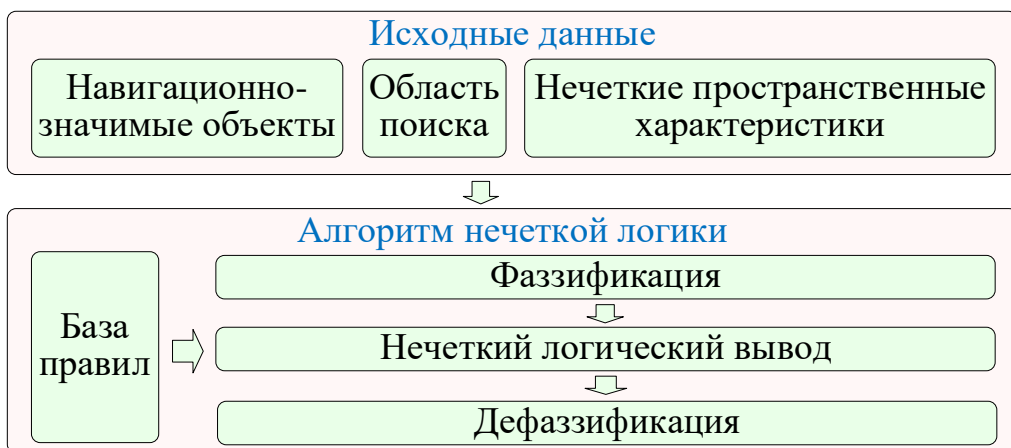
Рисунок 29 – Метод представления топологических отношений на основе нечеткой логики для навигационно-значимых объектов
