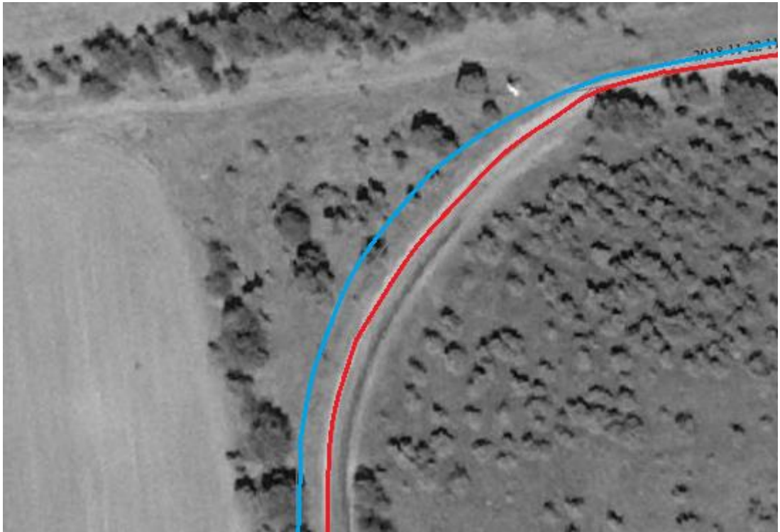
Рисунок 2.8.в - Расхождение треков при движении по кривой. Расхождение между треками на повороте дороги до 9 метров
