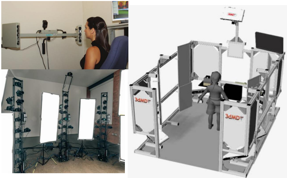
Рисунок 6 – Примеры фотоустановок для съёмки лица и тела человека 4
