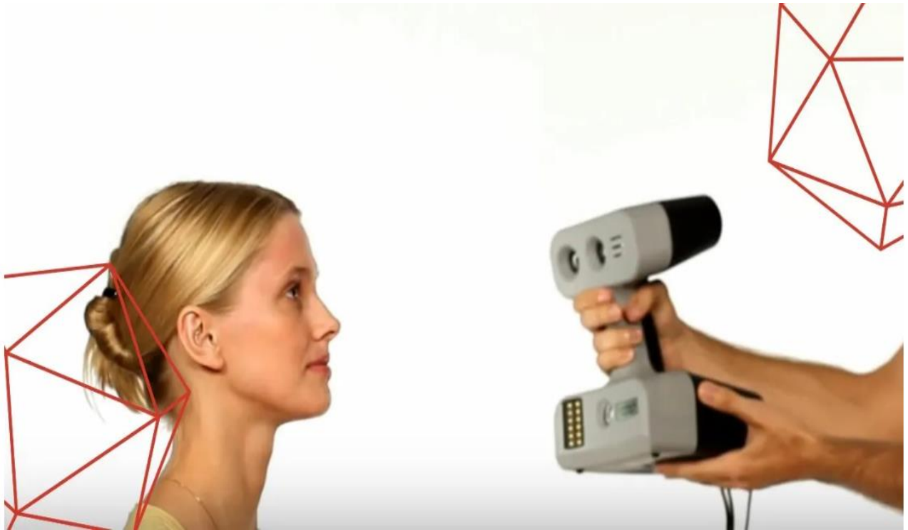
Рисунок 5 – Процесс оптического сканирования лица 3
