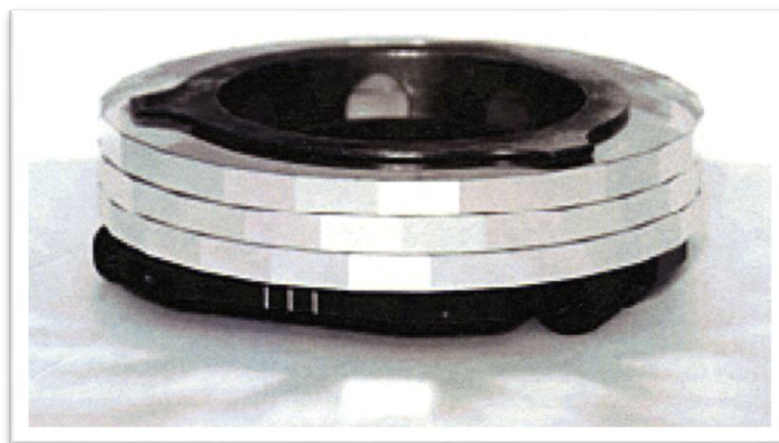
Рисунок 1.2. Опытный образец 72-гранной сапфировой призмы.
