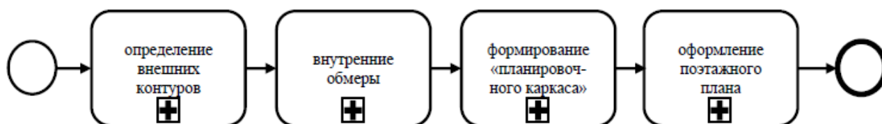
Рисунок 14 – Алгоритм создания поэтажного плана
