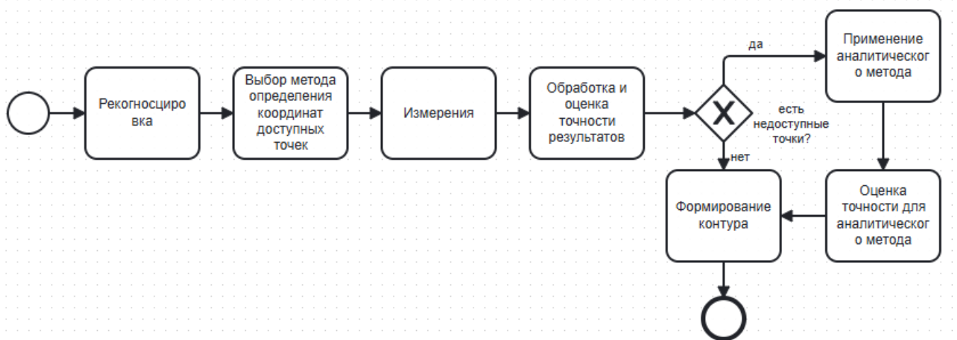
Рисунок 27 – Алгоритм определения координат контура ОКС
