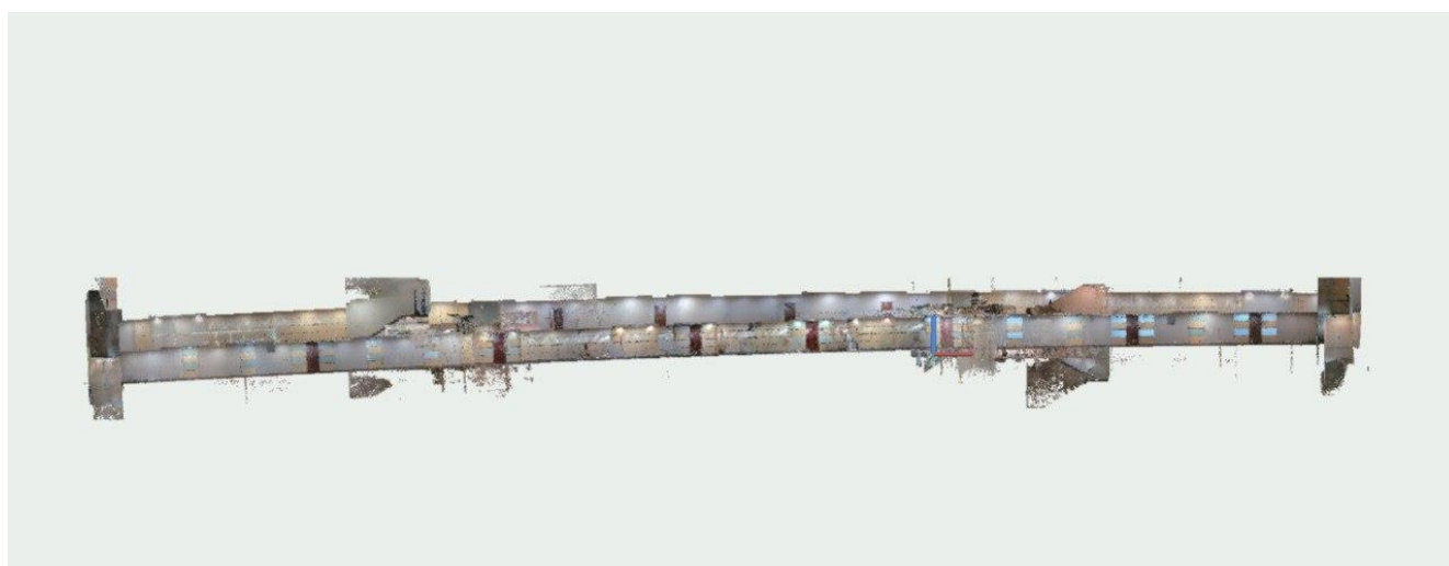
Рисунок 56 – Изгиб облака ТЛО по высоте
