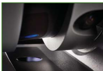
Рис. 6 Коллиматор, встроенный в подставку сканера
