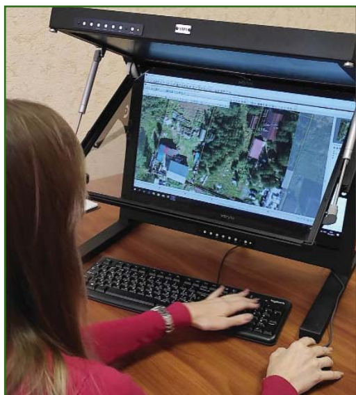
Рис. 3 Определение координат характерных то- чек границ земельных участков по стерео- модели специалистом филиала «ФКП Росреестра» по Свердловской области
