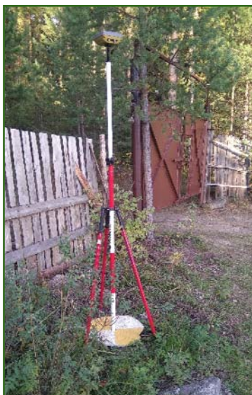
Рис. 2 Геодезические измерения на маркированных опозна- вательных знаках
